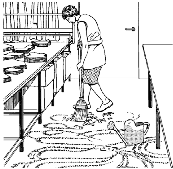
Hình 5: Một thói quen tốt, làm sạch sàn nhà xưởng ít nhất mỗi ngày một lần. Phun nước lên sàn nhà trước khi quét sẽ đỡ bụi.
