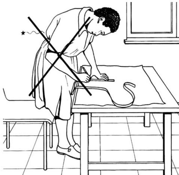
Hình 5: Độ cao làm việc quá thấp sẽ khiến công nhân chóng đau mỏi phần lưng dưới
