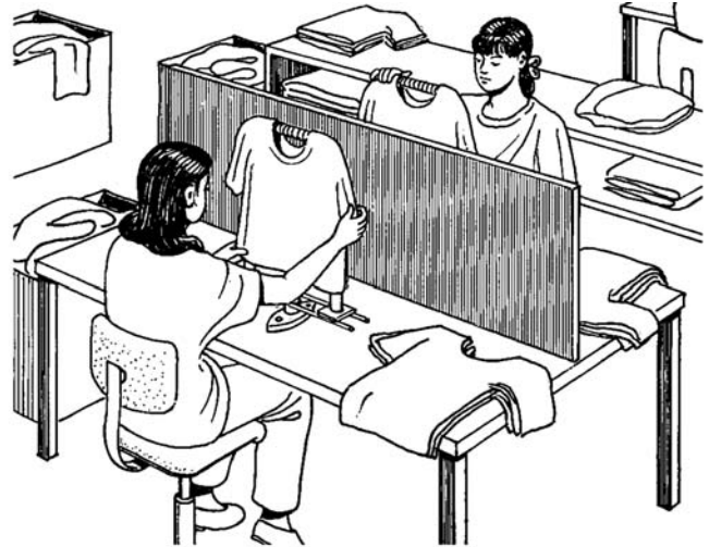
Hình 6 (b): Vị trí treo thấp sẽ hạn chế tầm nhìn. Điều này công việc cũng ảnh hưởng tới hiệu suất làm việc trong khâu kiểm tra chất lượng sản phẩm.
